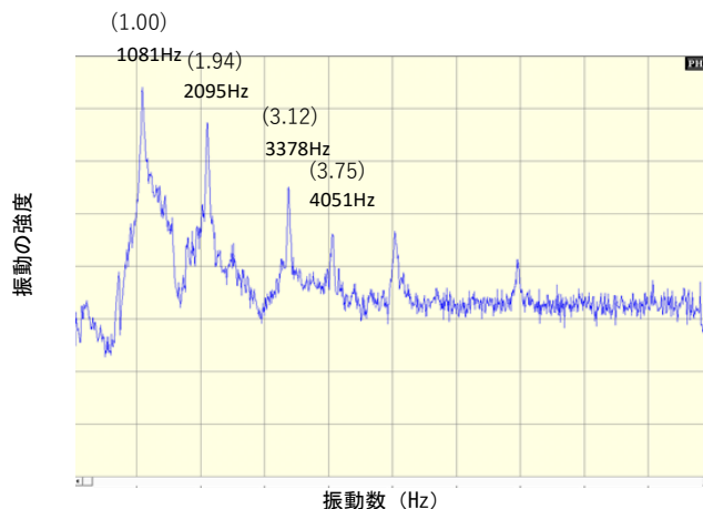
図3-2 フライパンをたたいた時に出る音の共鳴スペクトル フライパンをたたいてその音をマイクにとり、フーリエ解析にかけて共鳴スペクトルを取った。図3-4と比較するとそれ座俺のピークのすそ野が広がっている。
